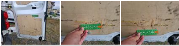
Porte de malle AR D, Bosse(s), LI - Réparer et peindre (complet)
