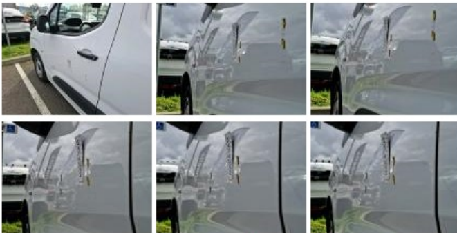
Moulure porte AVG, Griffe(s), Réparer/rempl. (montant forfaitaire)
