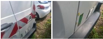
Porte de malle AR D, Bosse(s) et griffe(s), LI - Réparer et peindre (complet)
