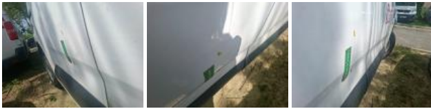
Moulure porte AVD, Griffe(s), Réparer/rempl. (montant forfaitaire)
