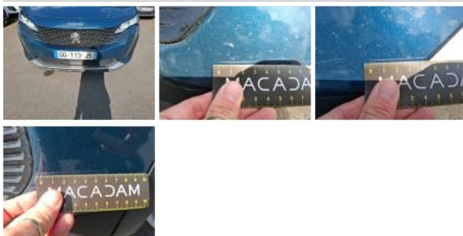
Pare-brise, Eclat(s), E - Remplacer
