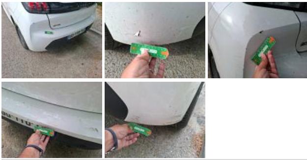
Moulure de pare-chocs AR, Cassé, E - Remplacer
