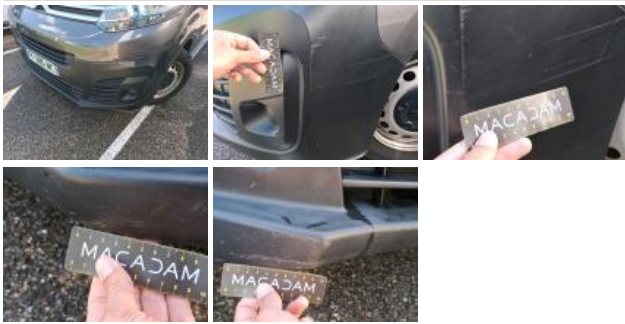
Panneau ARD, Bosse(s) et griffe(s), LI - Réparer et peindre (complet)
