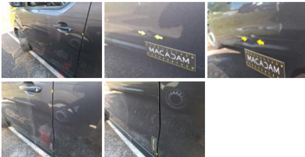
Panneau Latéral G, Bosse(s) et griffe(s), LI - Réparer et peindre (complet)
