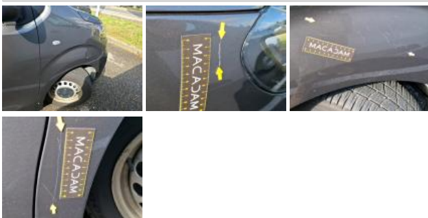
Moulure porte AVD, Griffe(s), Acceptable
