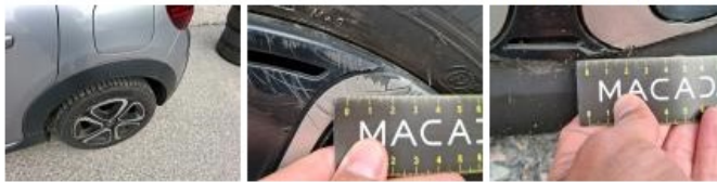
Moulure d'aile AVG, Dégrafé, Dépose/Répose
