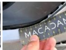
Moulure de pare-chocs AV, Dégrafé, Dépose/Répose
