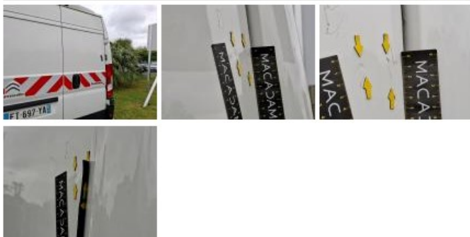
Coin pare-chocs ARD, Griffe(s), E - Remplacer
