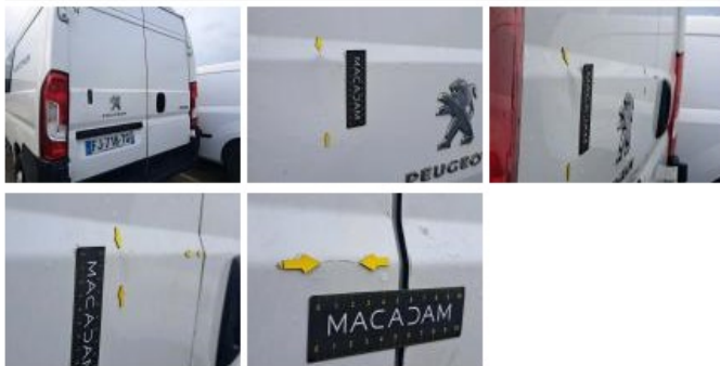
Porte de malle AR D, Bosse(s) et griffe(s), LI - Réparer et peindre (complet)
