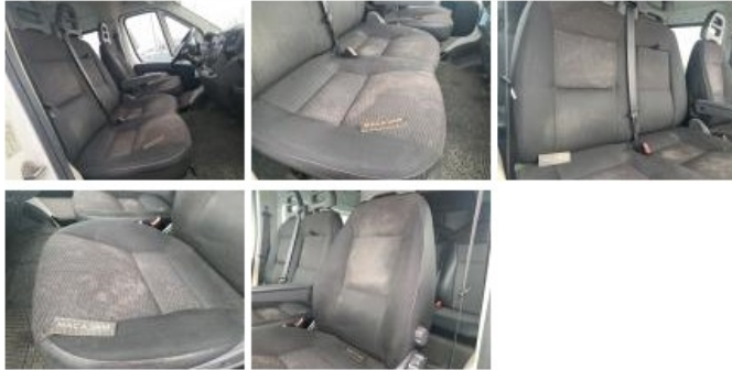
Revêtement assise siège AVG, Déchirure, E - Remplacer
