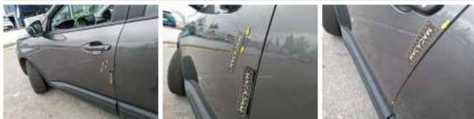
Moulure porte AVG, Griffes(s), Réparer/rempl. (montant forfaitaire)
