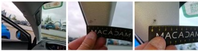
Ciel de toit, Brûlé, E - Remplacer
