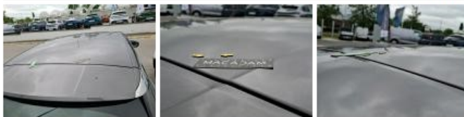
Pavillon, Bosse(s), LI - Réparer et peindre (complet)
