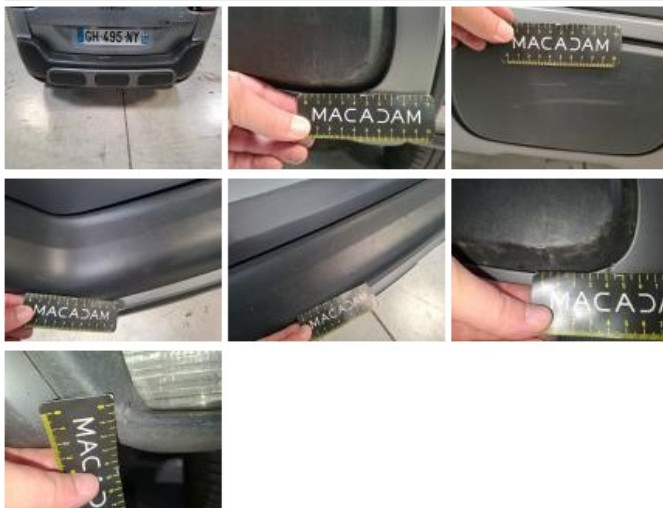
Moulure de pare-chocs AR, Cassé, Le - Remplacer et peindre
