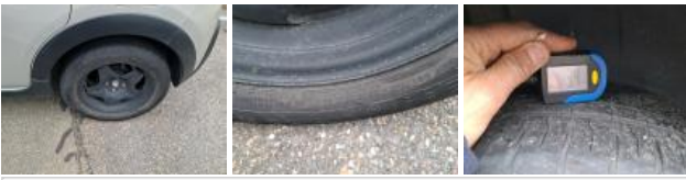
Pneu AVD, Hors tolérance, E - Remplacer
