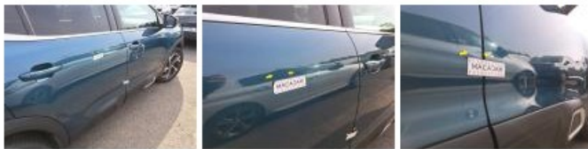
Moulure d'aile AVD, Dégrafé, Dépose/Répose
