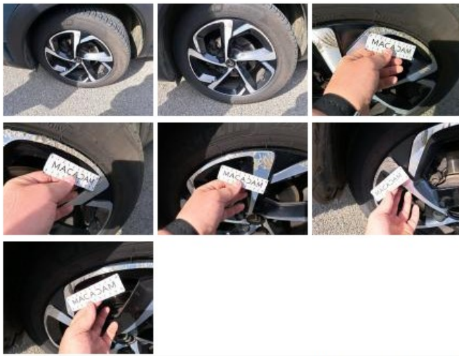
Jante alum. ARG bi-ton/polychrome, Dégâts chimiques, Acceptable
