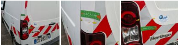
Porte de malle AR G, Bosse(s) et griffe(s), LI - Réparer et peindre (complet)
