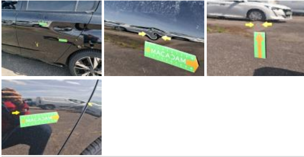
Bas de caisse ext G, Bosse(s) et griffe(s), Le - Remplacer et peindre
