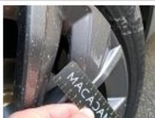
Jante alu ARD, Griffe(s), Réparer/remplacer (montant forfaitaire)
