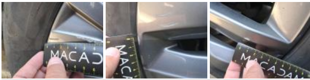
Pneu AVG, Déchirure, E - Remplacer
