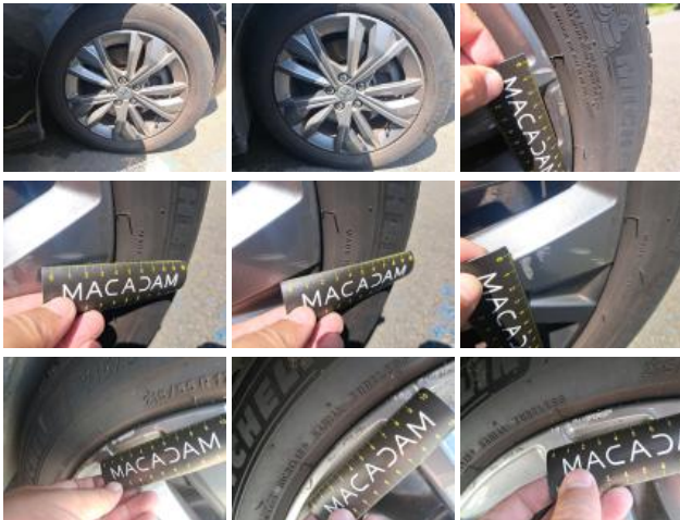
Pneu AVD, Hors tolérance, E - Remplacer
