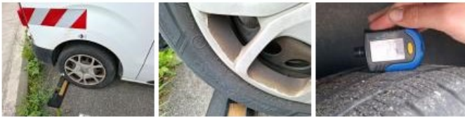
Pneu AVD, Hors tolérance, E - Remplacer
