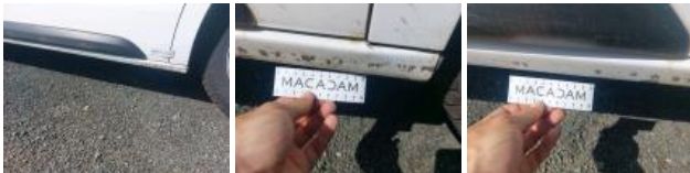
Porte coulissante D, Bosse(s), LI - Réparer et peindre (complet)
