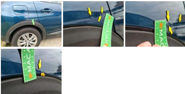
Porte ARD, Mauvaise réparation, Peindre
