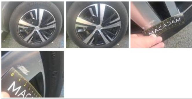
Pneu ARD, Hors tolérance, E - Remplacer
