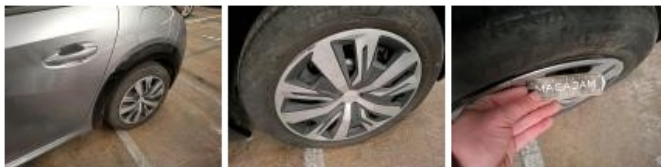
Enjoliveur de roue ARD, Déformé / Forcé, E - Remplacer
