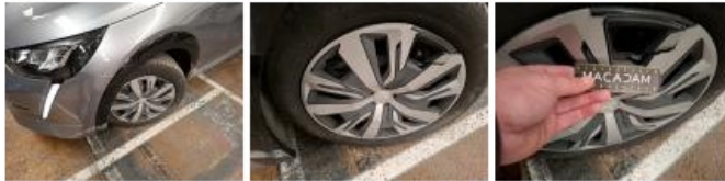
Enjoliveur de roue ARG, Déformé / Forcé, E - Remplacer
