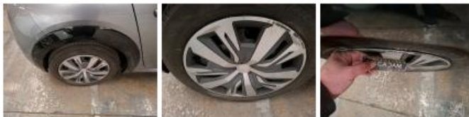
Enjoliveur de roue ARD, Déformé / Forcé, E - Remplacer
