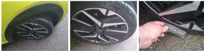
Pneu AVD, Déchirure, E - Remplacer
