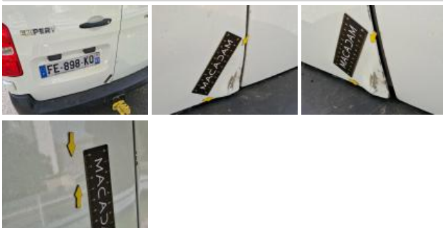
Joint de coffre/hayon, Déchirure, E - Remplacer
