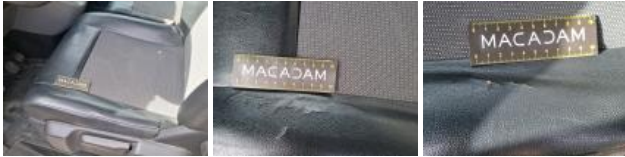
Revêtement assise siège AVD, Déchirure, E - Remplacer
