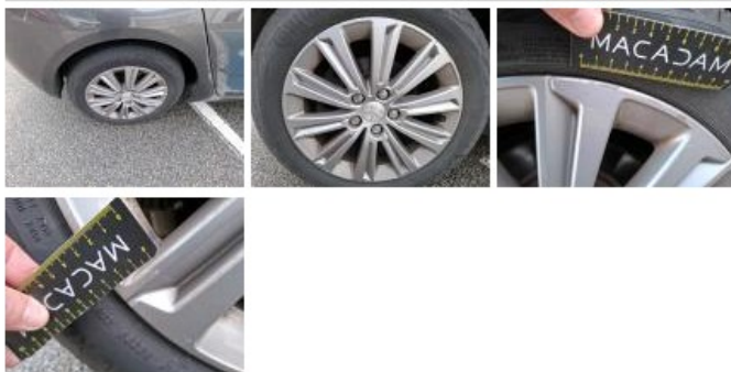
Jante alum. AVG, Griffe(s), Réparer/rempl. (montant forfaitaire)
