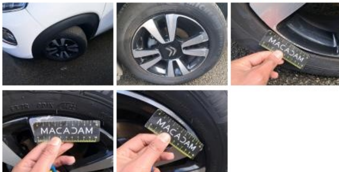
Pneu AVD, Hors tolérance, E - Remplacer
