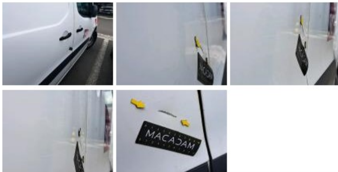
Coin pare-chocs ARG, Cassé, E - Remplacer
