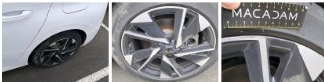
Pneu AVG, Hors tolérance, E - Remplacer
