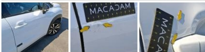
Moulure d'aile AVD, Griffe(s), E - Remplacer
