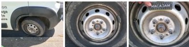
Pneu AVG, Hors tolérance, E - Remplacer
