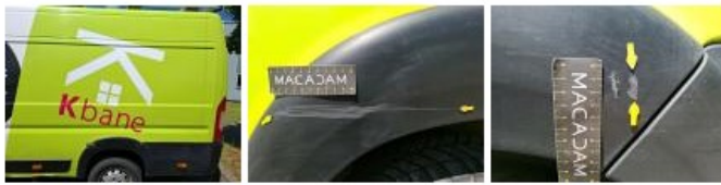
Pare-chocs AVD, Griffe(s), E - Remplacer
