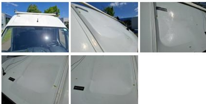
Pavillon cabine, Bosse(s) et griffe(s), LI - Réparer et peindre (complet)
