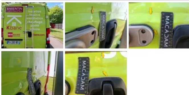
Barre choc AR, Cassé, LI - Réparer et peindre (complet)
