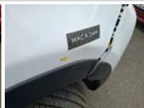
Aile AVD, Bosse(s) et griffe(s), LI - Réparer et peindre (complet)
