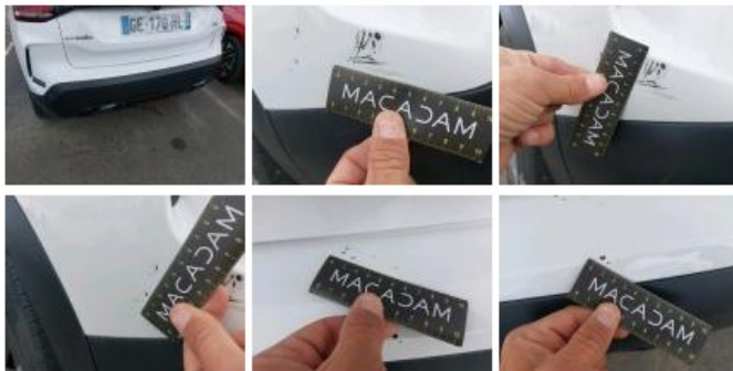
Pare-chocs AR, Griffe(s), E - Remplacer
