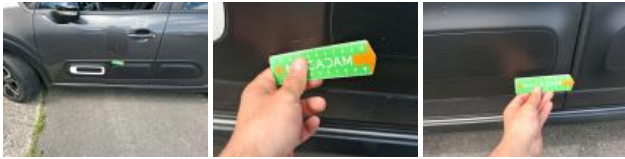
Moulure porte ARG, Griffe(s), Acceptable
