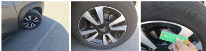
Pneu AVD, Hors tolérance, E - Remplacer
