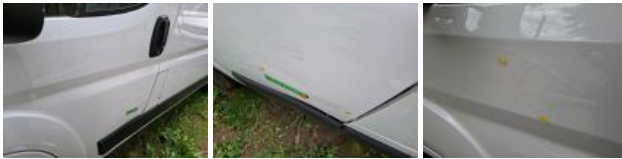
Moulure porte AVG, Cassé, E - Remplacer
