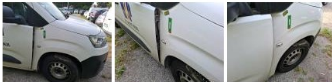
Coin pare-chocs ARG, Déformé / Forcé, LI - Réparer et peindre (complet)
