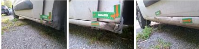
Moulure porte AVD, Griffe(s), Réparer/rempl. (montant forfaitaire)
