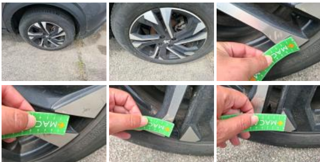
Pneu ARD, Hors tolérance, E - Remplacer
