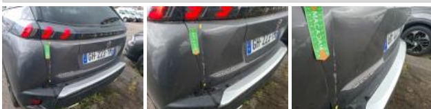
Pare-chocs AR, Cassé, E - Remplacer
