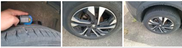
Pneu AVD, Hors tolérance, E - Remplacer
