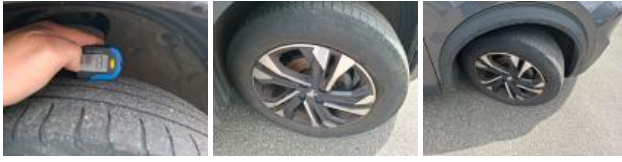
Pneu AVD, Hors tolérance, E - Remplacer
