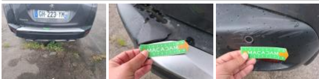
Moulure de pare-chocs AR, Cassé, E - Remplacer
