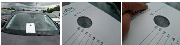
Pare-brise, Fêlure, E - Remplacer
