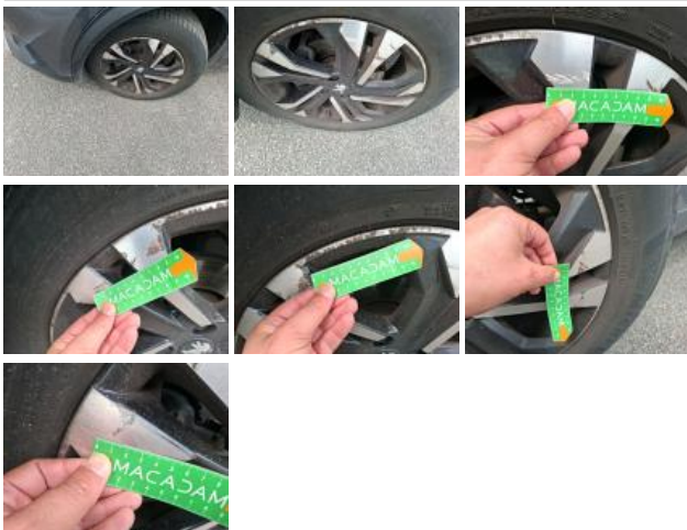
Pneu ARG, Hors tolérance, E - Remplacer
