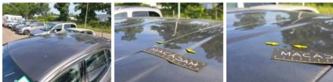
Pavillon, Bosse(s), LI - Réparer et peindre (complet)
