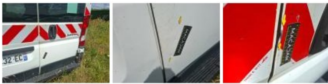
Moulure de coffre, Dégrafé, Dépose/Répose
