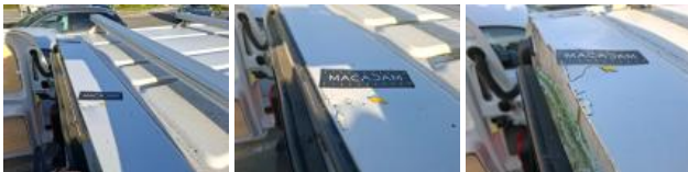
Renfort pavillon AR (au dessus portes AR), Bosse(s) et griffe(s), LI - Réparer et peindre (complet)
