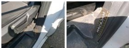
Bas de caisse int AVG, Bosse(s) et griffe(s), LI - Réparer et peindre (complet)
