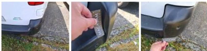
Coin pare-chocs ARD, Déformé / Forcé, E - Remplacer
