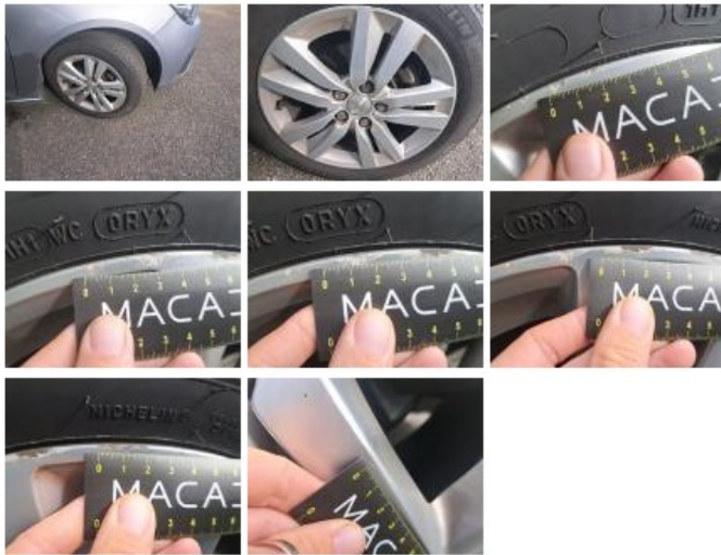
Répétiteur G, Fêlure, E - Remplacer
