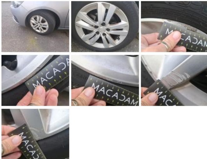
Pneu ARG, Hors tolérance, E - Remplacer
