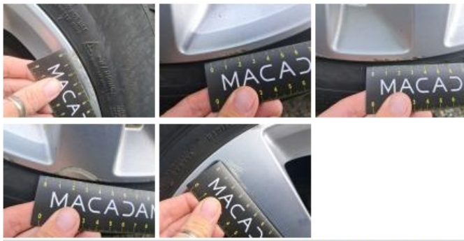
Jante alum. AVD, Griffe(s), Réparer/remplacer (montant forfaitaire)
