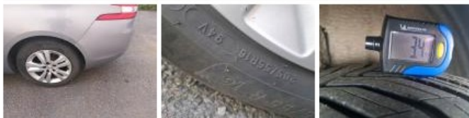
Pneu ARD, Déchirure, E - Remplacer
