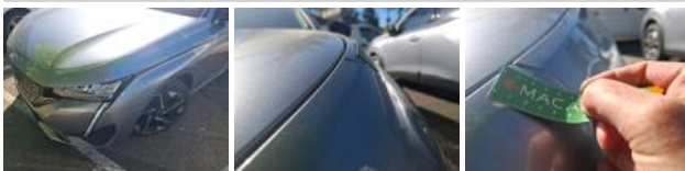
Pare-chocs AVG, Mauvaise réparation, Peindre
