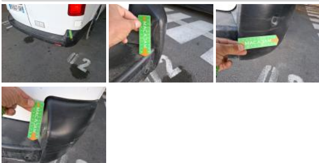
Pare-chocs AR, Déformé / Forcé, E - Remplacer
