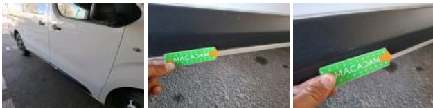
Coin pare-chocs ARG, Déformé / Forcé, E - Remplacer
