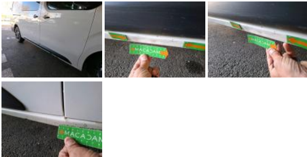
Moulure porte AVD, Griffes(s), E - Remplacer
