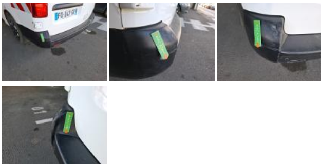
Coin pare-chocs ARD, Déformé / Forcé, E - Remplacer
