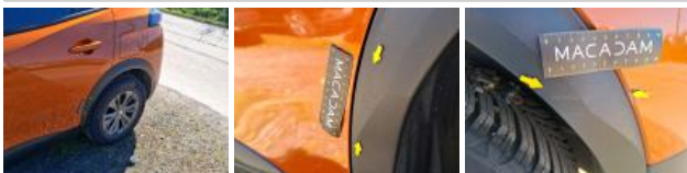
Moulure porte ARG, Griffe(s), Acceptable
