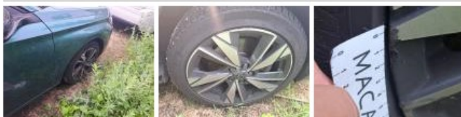
Jante alum. AVD bi-ton/polychrome, Déformé / Forcé, E - Remplacer
