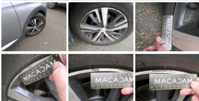
Pneu AVD, Déchirure, E - Remplacer
