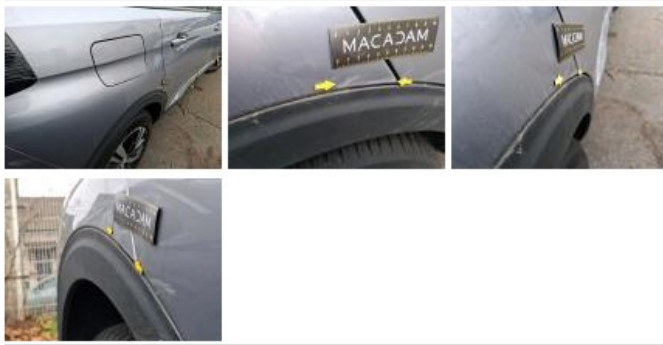
Moulure d'aile ARD, Griffe(s), Acceptable
