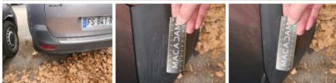
Capteur de parking AR, Manque, E - Remplacer
