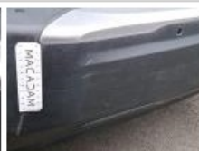
Pare-chocs AR, Griffe(s), E - Remplacer
