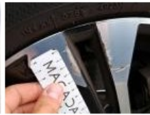
Pneu ARD, Hors tolérance, E - Remplacer
