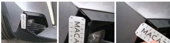
Moulure de pare-chocs AV, Manque, E - Remplacer
