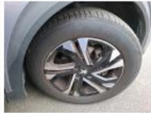
Jante alum. AVD bi-ton/polychrome, Griffes(s), E - Remplacer
