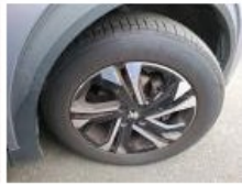
Jante alum. AVD bi-ton/polychrome, Griffes(s), E - Remplacer
