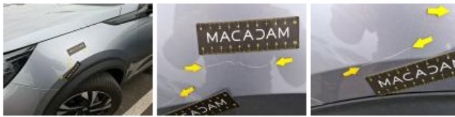
Moulure d'aile AVG, Griffe(s), E - Remplacer
