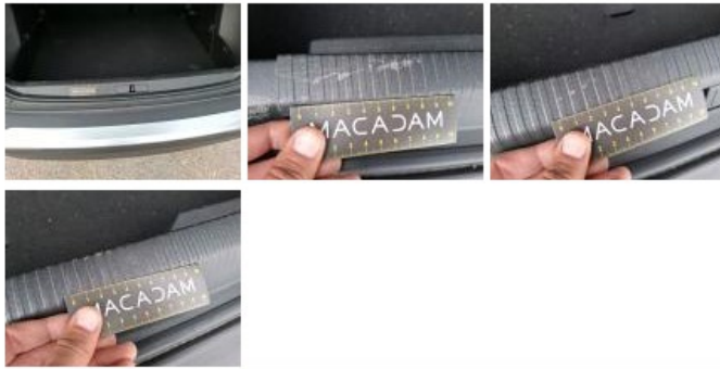
Joint de coffre/hayon, Déchirure, E - Remplacer
