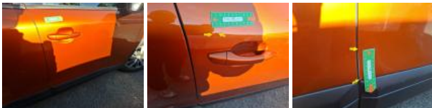
Moulure porte AVD, Griffe(s), E - Remplacer
